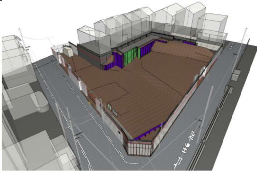
ステップ09 現況地盤（山留打設前）
