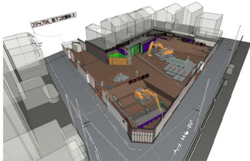
ステップ06 地下2次解体-3
