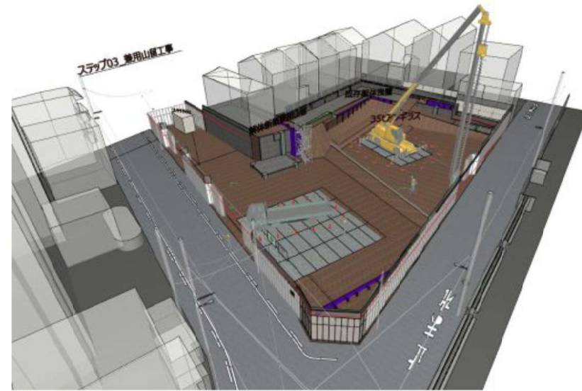
ステップ03 兼用山留工事
