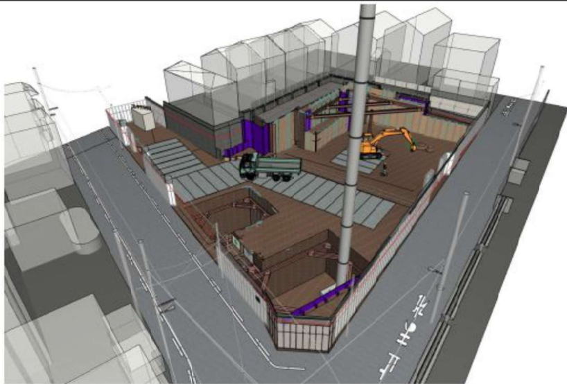
ステップ17 2次掘削工事-2
